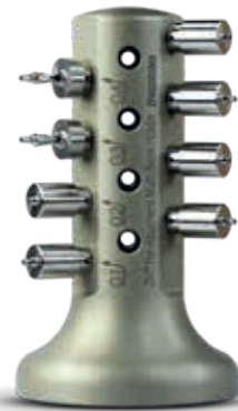
מחזיק מבנה גולמי עם מיקומים ריקים של Zfx מאפשר מיקום וניהול של 12 בלוקים לכל היותר.
